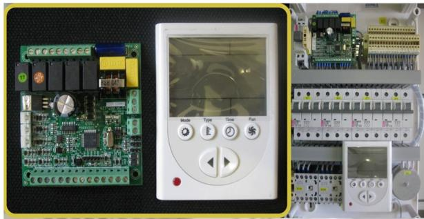
*Система автоматического управления установкой состоит из щита управления и выносного пульта, который позволяет на значительном расстоянии управлять установкой. Система управления управляет работой установки, контролирует все параметры системы, следит за датчиками и защищает установку в нештатных ситуациях.*
